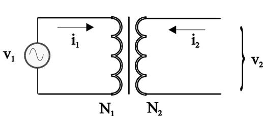
El transformador es considerado una **máquina eléctrica** a pesar de no tener partes móviles.
