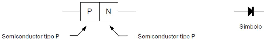
Se construye mediante la unión de dos partes de material semiconductor (en general silicio) de naturalezas P (positivo) y N (negativo) según su composición a nivel atómico
