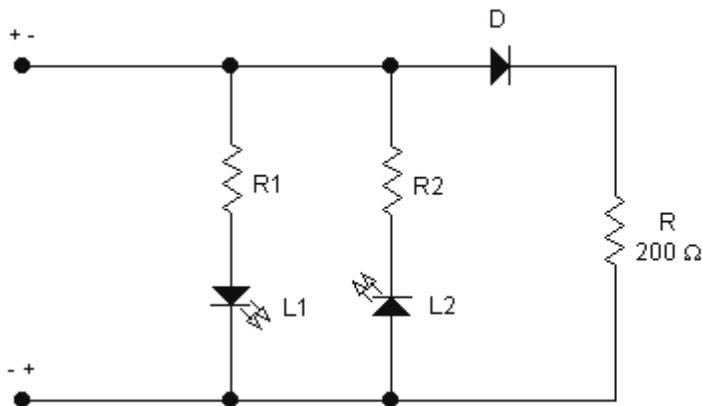
El circuito de la figura es utilizado para controlar la polaridad con que se alimenta la carga R. Se utilizan dos led's, de colores verde (L1) y rojo (L2) para su indicación. La tensión de alimentación del circuito es 12 V. Calcular las resistencias  $R_1$  y  $R_2$  necesarias y todas las corrientes para ambas posibilidades.
