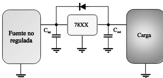
El condensador de entrada **no es el condensador de filtro de la fuente**, es un condensador auxiliar que sólo debe ponerse si la distancia de la fuente al regulador es mayor de 10 cm.
